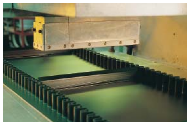
Applicazione di profili con macchina saldatrice ad ALTA FREQUENZA
