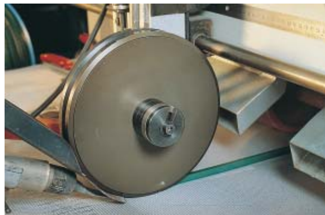
Applicazione di profili con macchina saldatrice ad ARIA CALDA
