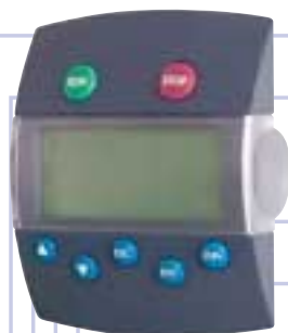
Tastiera di programmazione asportabile con funzione copia parametri
